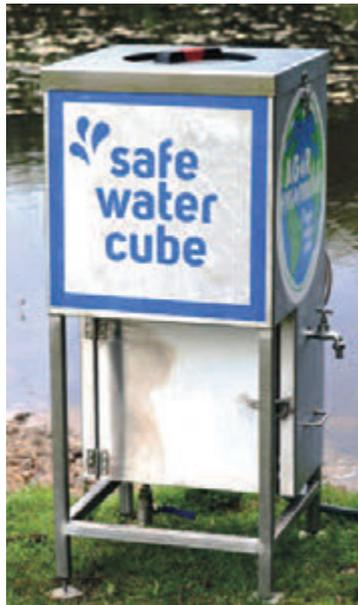
Baptisée "Safe Water Cube", l'invention permet de traiter 1.000 litres d'eau afin de la rendre potable en seulement une heure. Un rendement particulièrement important qui ne demande aucune source électrique.
