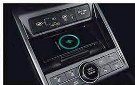
Tapis de Chargement Sans Fil, Mode Conduite / Mode Terrain avec Fonction de Maintien Automatique
